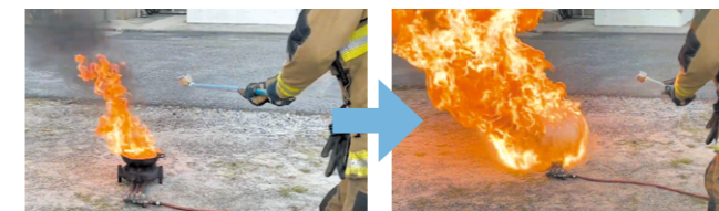
▲コンロ火災が起きた鍋に水をかけ、炎が燃え広がる様子
