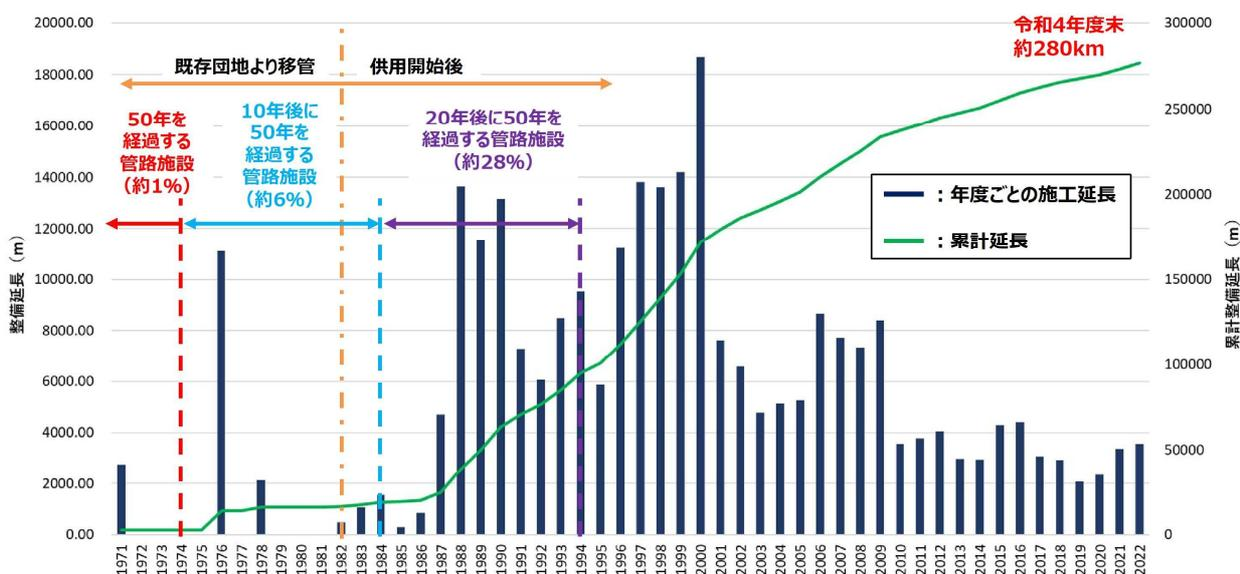
2023年度時点で管路施設の標準耐用年数(50年)を約1%が経過しています。しかし今後、加速度的に老朽化が進行し、維持管理費や改築費の増加が見込まれます。(20年後までに35%程度老朽化が進行)
