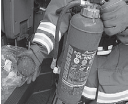
▲破損し底部が破裂した消火器
