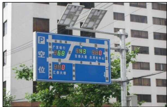
▲駐車場の残数を表示した案内板（海外事例）
