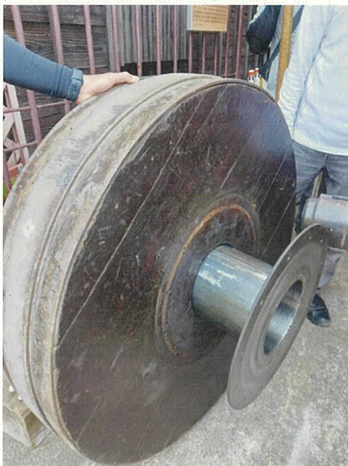
右前輪（座板＋釜金物の脱落）
