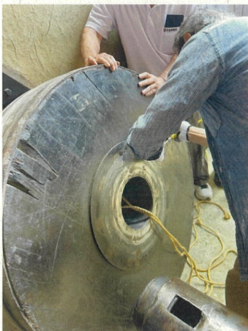
左前輪（見付面にも傷みあり）
