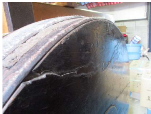
現車輪（見附面割損部）
