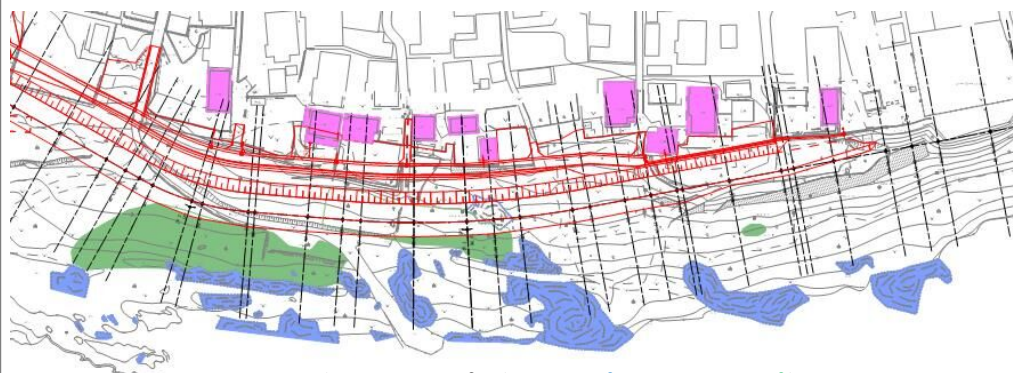
例2 川表に擁壁を設置
