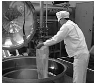
生薬から原薬を抽出している工程
