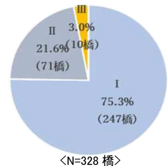
図-4.1 対象橋梁の健全度評価
