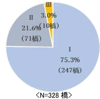
図-4.1 対象橋梁の健全度評価
